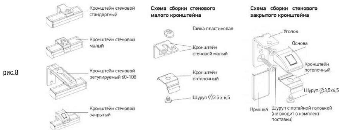
При наличии подоконных кронштейнов, опоры для них крепятся на стеновые кронштейны при помощи винта М3х6 и гайки М3 как показано на рисунках ниже. Опоры на правые кронштейны крепятся в правое отверстие, на левые соответственно в левое. Стеновые закрытые кронштейны уже имеют опоры, на которые надеваются подоконные кронштейны (рис.9). Все стеновые кронштейны прикручиваются двумя шурупами (не входят в комплект) к стене или раме окна.
