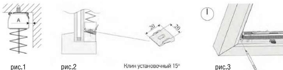
3. При наличии подоконных кронштейнов отметьте ширину изделия в месте установки (I). Вставьте опору с шайбой в установочный упор (II) и отметьте место сверления (III). Просверлите отверстие 2 мм и прикрутите опору шурупом 3,9 x 13. Внешние кромки опор должны совпадать с размеченными линиями ширины изделия (рис.4).
